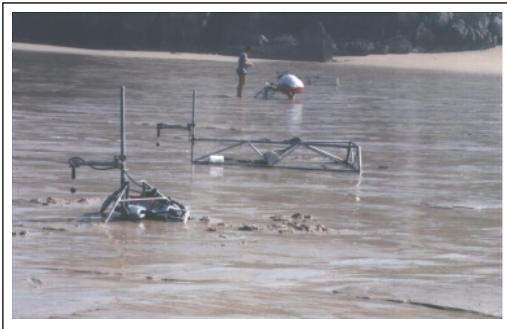
SENSORES DE VELOCIDAD Y DE PRESIÓN PARA LA MEDIDA DE PARÁMETROS HIDRODINÁMICOS
